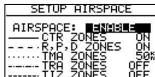
Danach finden Sie bestimmte Luftraumgruppen, die einzeln ein-, und ausgeschaltet werden können (ON/OFF) oder mittels einer Kilometerangabe nur bei bestimmten ZOOM-Stufen (siehe Kapitel 3.4) angezeigt werden. Letzterer Punkt dient der Ersparnis von Rechenzeit im Prozessor und macht das Display bei kleinen Maßstäben übersichtlicher (damit es nicht so aussieht wie in der Grafik unten...)
