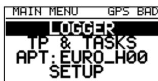
Zuerst soll der Logger auf einen neuen Piloten, ein neues Flugzeug usw. eingestellt werden (Erstellen einer neuen Flight Info). Dies geschieht im Untermenü LOGGER. Wählen sie dieses Untermenü aus, indem sie mit den UP/DOWN [^]/[v] Tasten den Cursor auf LOGGER bewegen (direkt nach dem Startvorgang steht er bereits dort) und dann [ENTER] drücken.
